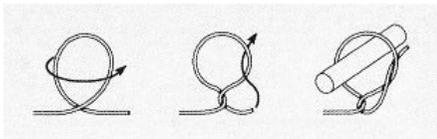
次に響板の穴（アイレット）から出た弦をチューニングピンの穴に通して下さい。
